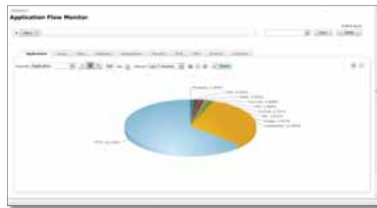
Application Flow Monitor liefert Echtzeit-Grafiken zu Anwendungen, zur Bandbreitenbelegung in ein- und ausgehender Richtung, zu aktiven Website-Verbindungen sowie zur allgemeinen Benutzeraktivität.
